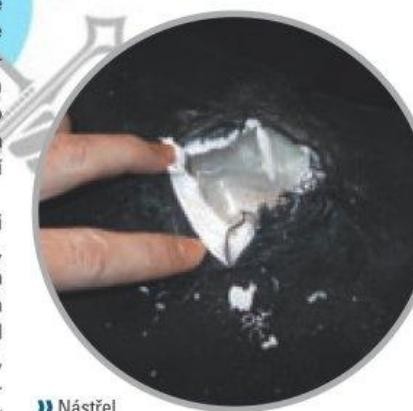
► Nástrel jednotnou střelou brokovné ráže 12. Pod roztrženou balistickou tkaninou je fólie vysokopevnostního polyetylénu.
